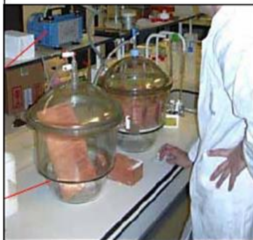
Ensayo de saturación al vacío
