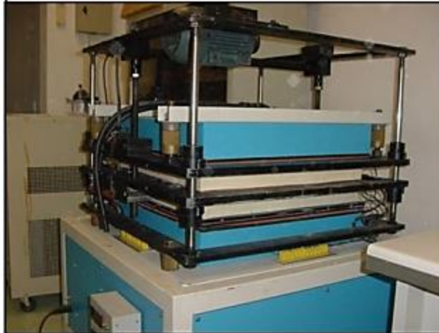
Método de la placa caliente guardada (EN 12667:2002 y UNE 92201:1989)
