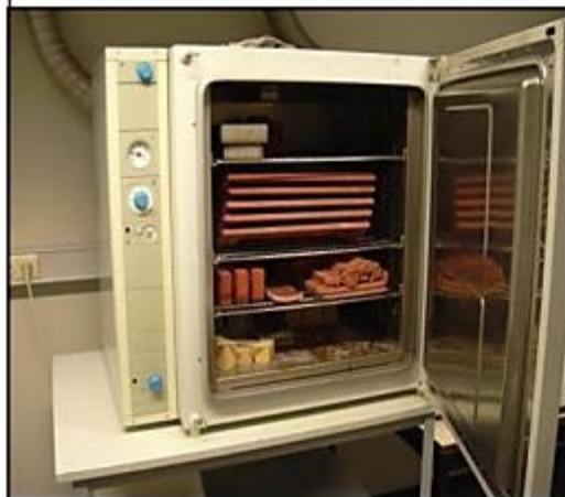
Ensayo de permeabilidad al vapor (UNE-EN ISO 12572: 2002)
