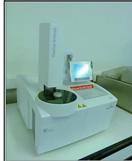
Equipo DSC. Medida del calor específico
