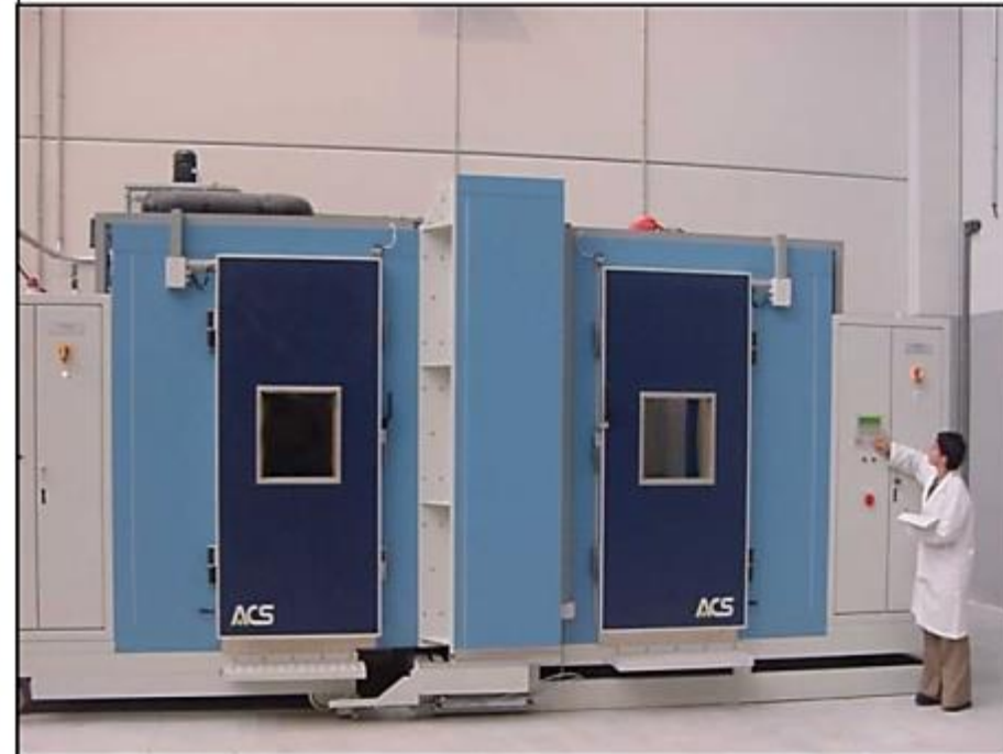
Medida de la transmitancia térmica de cerramientos opacos (UNE 92204:1995)
