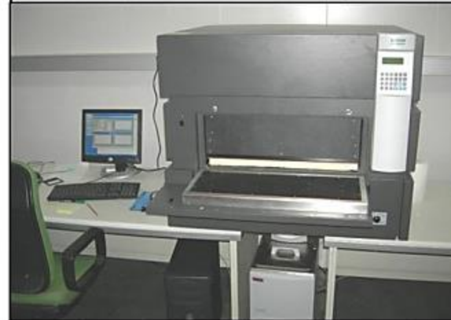
Método de la medida del flujo de calor (UNE-EN 12664:2002)
