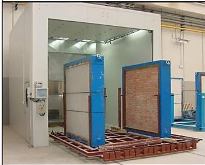
Medida de la transmitancia térmica de cerramientos opacos (UNE 92204:1995)
