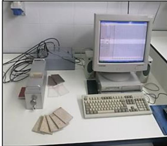
Método de la lámina calefactora (ASTMC- 1114 – 06)
